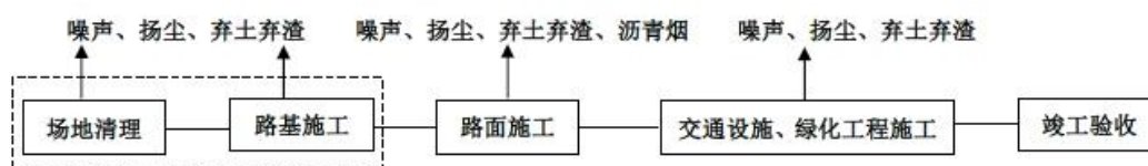
图 4-4 道路工程施工工艺流程及产污环节示意图
