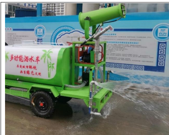
施工期洒水除尘
